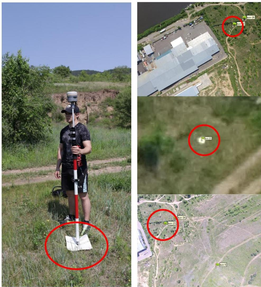
Рис. 4. Наземные метки контрольных точек (слева – вид с земли; справа – вид с высоты 150 м) /
